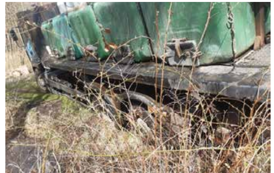
Durch Bibergrabung eingebrochener Fischtransport (Foto: A. Kittner)
